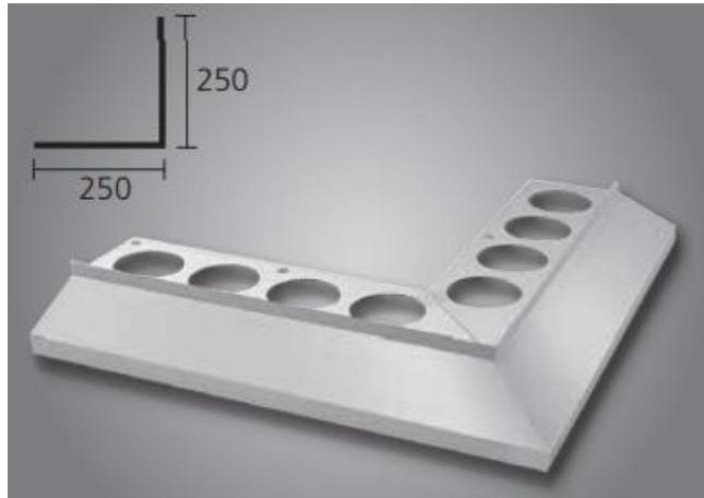
*Balkonu ārējā stūra profils MAXI – ar lāseni un pārlaidumu; Profilu, galvenokārt, izmanto, lai novadītu ūdeni no balkona, terašu un lodžiju konstrukcijām.*
