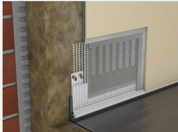
**Pielietojums – Savienojuma profils metāla elementu savienošanai ar siltināšanas sistēmu ETICS.** Profila gropē ievieto metāla elementu, kas savienojuma vietā darbojas kā deformācijas šuve starp siltināšanas sistēmu un metāla elementu. Profila läsenis nodrošina mitruma novadīšanu no ETICS apdares kārtas. Stikla šķiedras siets atbilst ETAG 004 prasībām.
