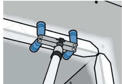
Der Außenkantenroller „Wetstick-Rolling-Tool WSR“ ermöglicht ein gleichmäßiges Andrücken des „Big-Stick 300“ und damit eine noch schnellere und zusätzlich effizientere Verarbeitung. Hinweis: Beachten Sie zur Eignung des Rollwerkzeuges die jeweiligen Komposit- und Werkzeug-Datenblätter.
