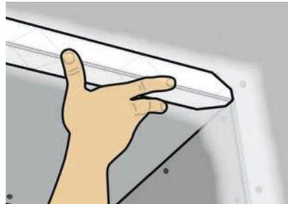
Drücken Sie den „Big-Stick 300“ in den feuchten Spachtel und richten sie diesen bei Bedarf aus, um eine gerade Kante zu erhalten.
