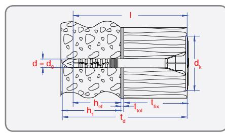
Determination of maximum thickness of insulation material:  $t_{fix} = L - t_{tol} - h_{ef}$  / Bepaling van de maximale dikte van isolatiemateriaal:  $t_{fix} = L - t_{tol} - h_{ef}$
